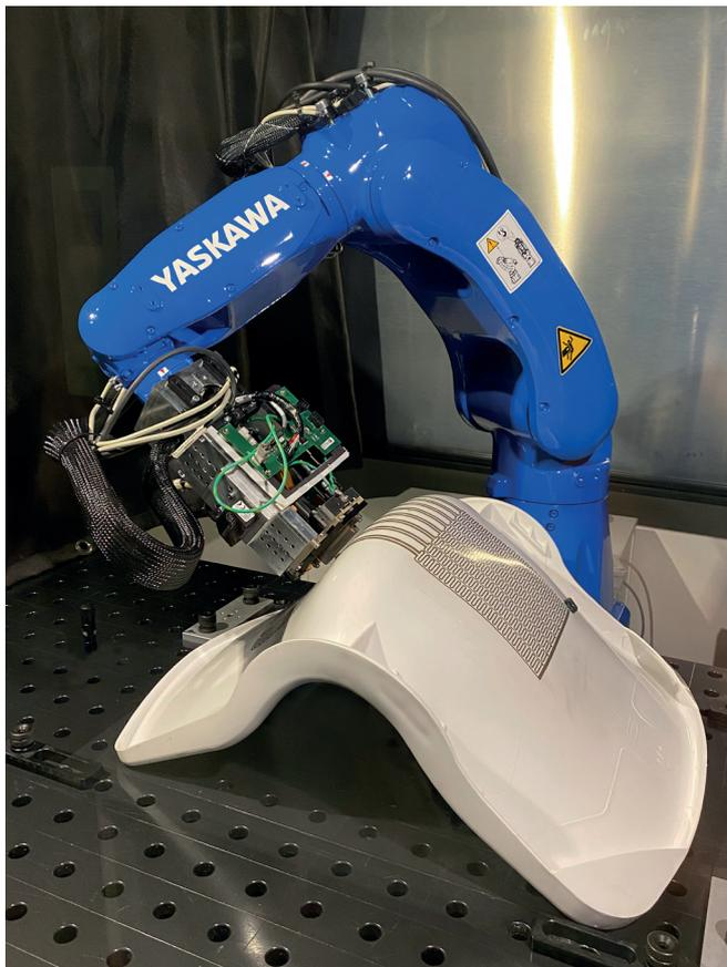
**Robotergeführter Inkjet-Druck einer Heizleiterstruktur für eine beheizbare Sitzschale: Versuchsstand am Fraunhofer ENAS mit Roboter Yaskawa GP8. (Bild © Fraunhofer ENAS)**
